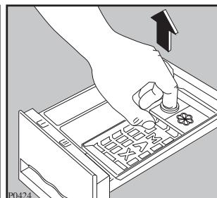
Стиральный порошок скапливается и в углублении дозатора. Для чистки углубления можно использовать старую зубную щетку. После чистки установите дозатор на место, и включите программу стирки без белья.
